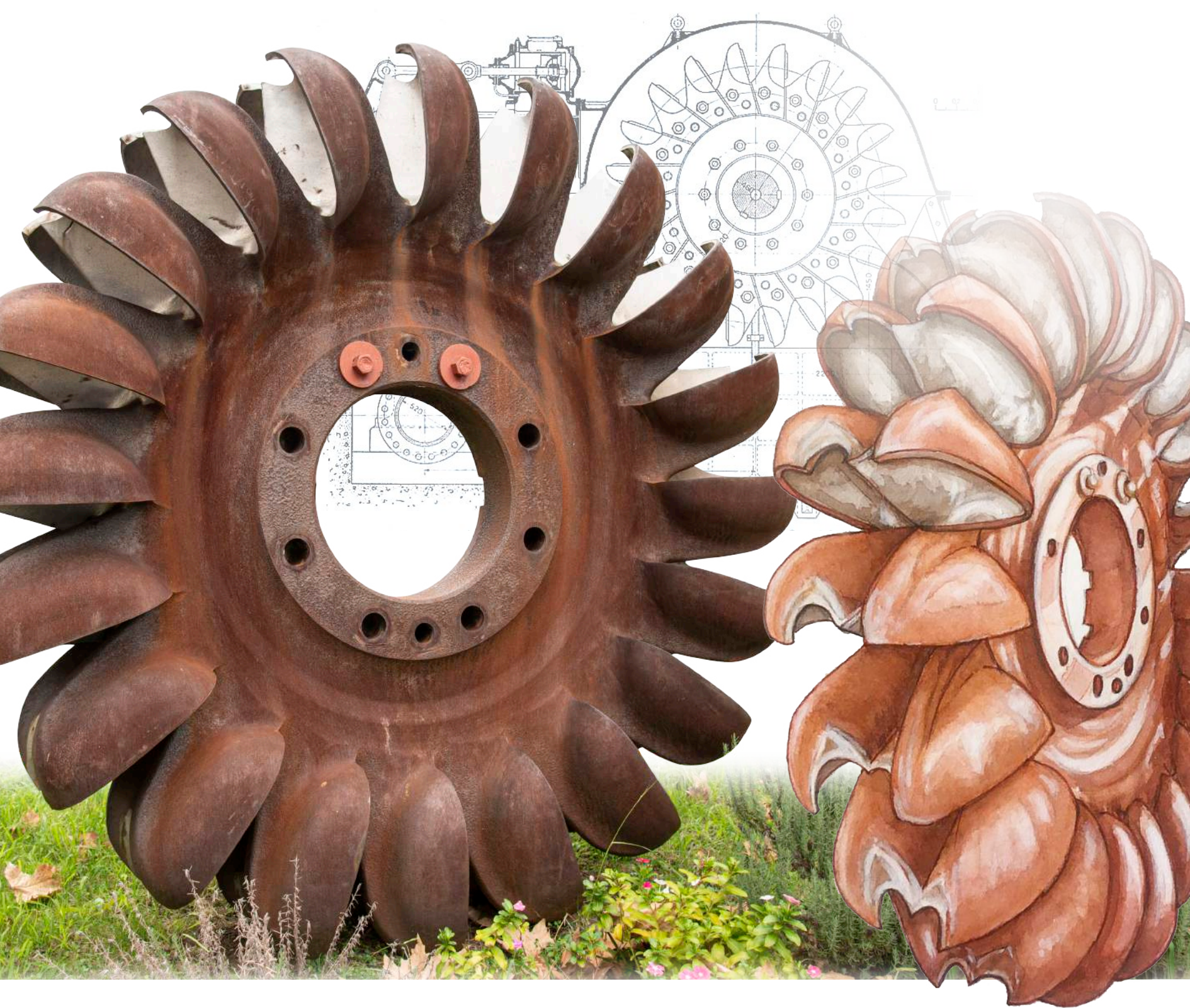
Girante di turbina Pelton | Pelton wheel rotor • Ghisa ed acciaio al carbonio | Cast iron and carbon steel Eseguita negli stabilimenti meccanici Riva-Calzoni di Milano nel 1939. Progetto dell' Ing. G.Ucelli, esecuzione di maestranze rimaste sconosciute Built at the Riva-Calzoni factory in Milan in 1939. Designed by Eng. G. Ucelli, built by still-anonymous workers.
